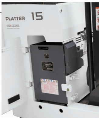
安全増防爆構造のバッテリー
