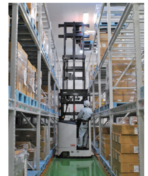
車幅とほぼ同等の道路幅で荷役作業ができ、スペースを有効利用。
