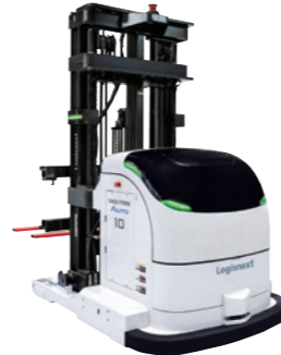
■ラックフォークオート 3方向荷役が可能なパワフルな無人フォーク。 磁気誘導方式とレーザー誘導方式の 2タイプをご用意。
