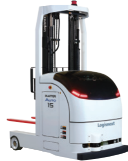
■プラッターオート プラッターの特性を活かした無人フォーク。 磁気誘導方式とレーザー誘導方式の 2タイプをご用意。
