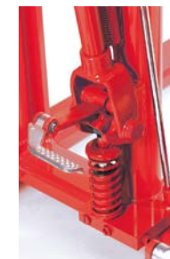
早揚り装置 早揚りマジックペダルを踏むとリフト上昇スピードが3倍にアップ。作業効率を高めます。(無負荷時)
